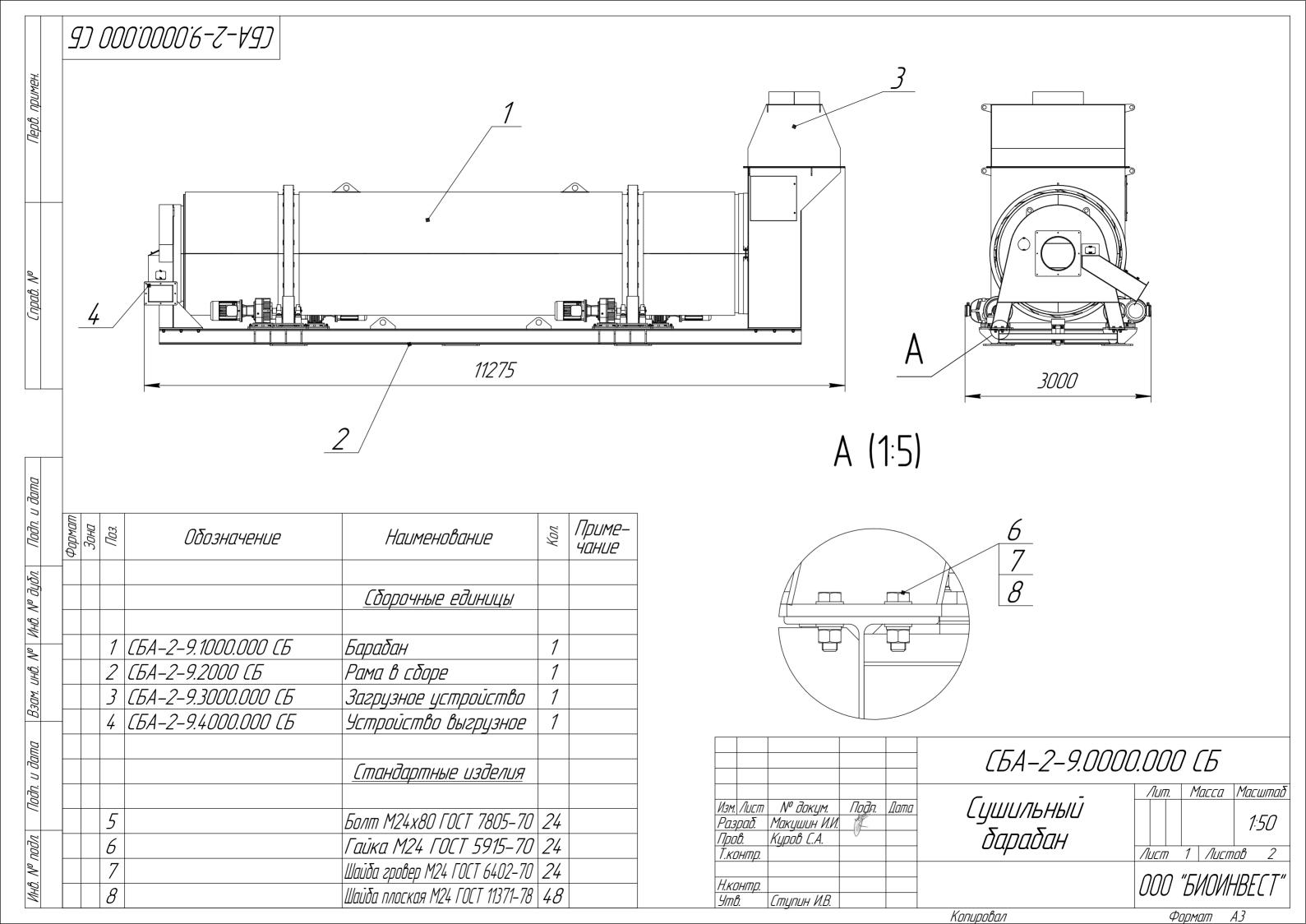
1 \*Размеры для справок; 2. После монтажа барабан проверить на холостом ходу. При работе, наличие посторонних шумов не допускается. Номинальное положение барабана – бандаж не касается упорных роликов.
